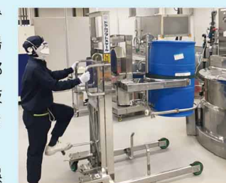
約200キロの原料をハンドリフトで製造釜に投入
