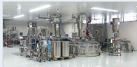
生産設備は5トンのオープン釜や3トンの真空乳化釜など
